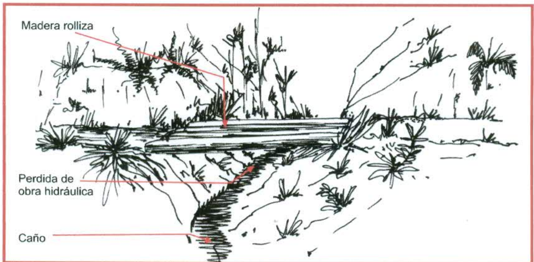
Figura 29. Obra hidráulica pérdida – reportada como superficial en madera e intervención reciente
