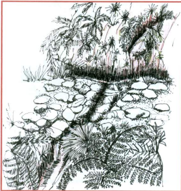
Figura 22. Obra hidráulica superficial transversal abierta
