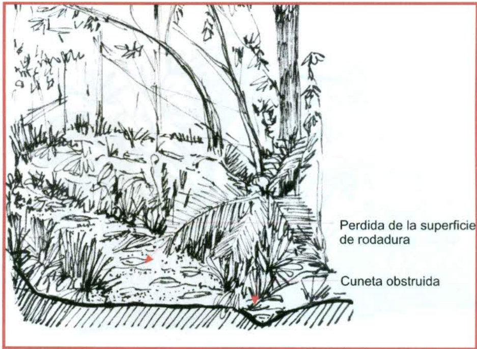
Figura 21. Pérdida de la carpeta o sin carpeta
