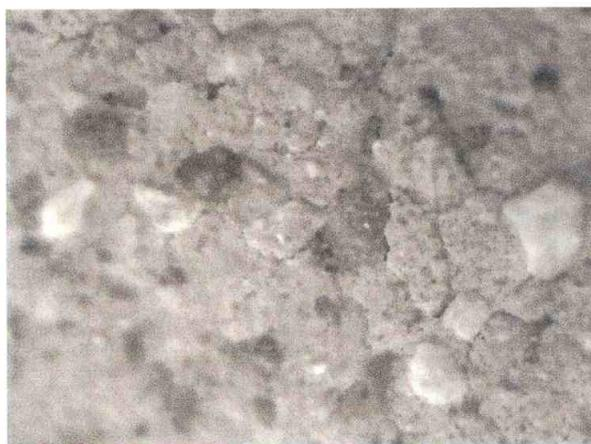
**Foto 19. Composición mineralógica de la pasta (granos finos-medios). Obsérvese las arenas y orblendas. Zoom 20mmx45mm.**
